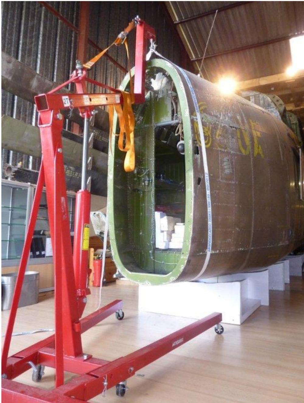
Sur ce cliché, nous retrouvons ici notre cellule débarrassée de son moteur et de tous ses équipements et sans son cône de queue. Ainsi dénudée, nous pouvons démarrer les travaux de réparation cellule avec échange des tôles Aluminium/Magnésium corrodées par des tôles entièrement Aluminium.
